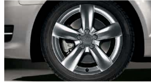
Aluminium-Gussräder im 5-Arm-Dynamik-Design anthrazit, Größe 7,5 J x 17 mit Reifen 225/45 R 17 (wahlweise mit Reifen mit Notlaufeigenschaften)
