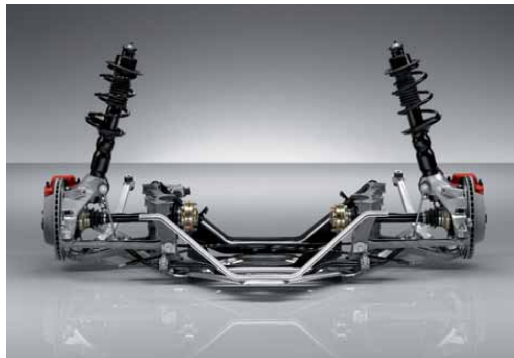
McPherson-Hinterachse mit Querlenkern, Federbeinen beim Cayman S
