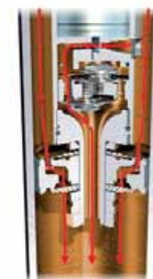
Zugstufe – Arbeitskolben und Bypass, sportlich-komfortable Abstimmung
