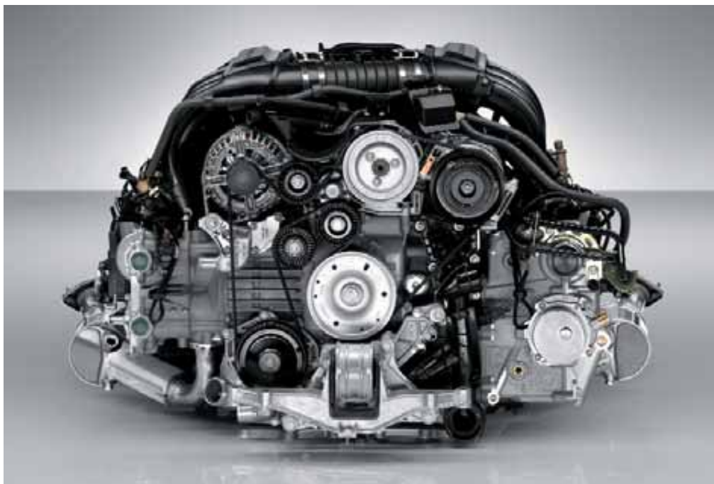
3,4-Liter-6-Zylinder-Boxermotor des Cayman S
