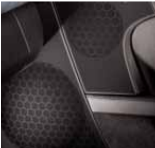
8,0-cm-Neodym-Mitteltonlautsprecher und 20,0-cm-Nd®-Tief- tonlautsprecher*
