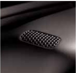
Mikrofon für AudioPilot™ auf der Lenksäule
