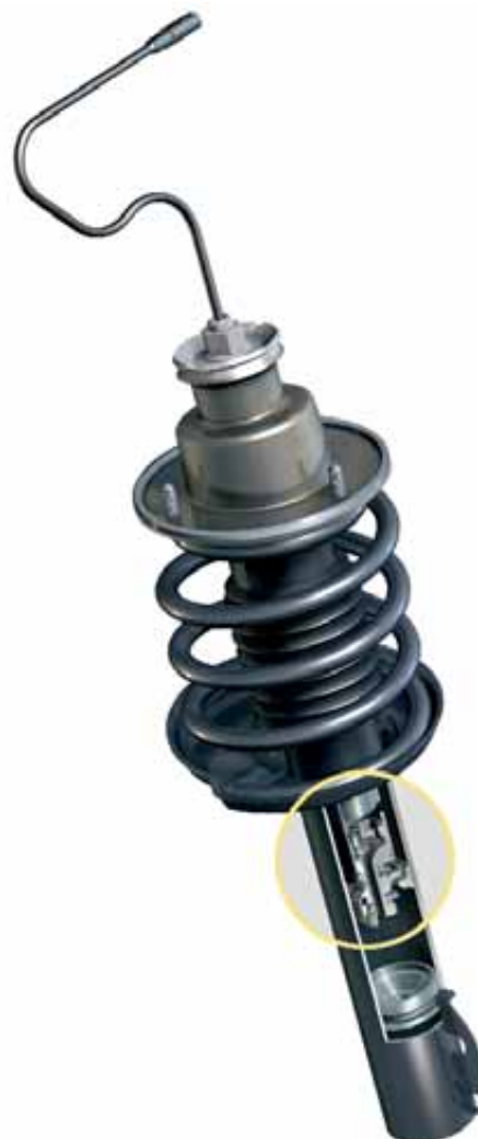
Zugstufe – Arbeitskolben und Bypass, sportlich-komfortable Abstimmung
