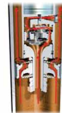
Druckstufe – Arbeitskolben und Bypass, sportlich-komfortable Abstimmung
