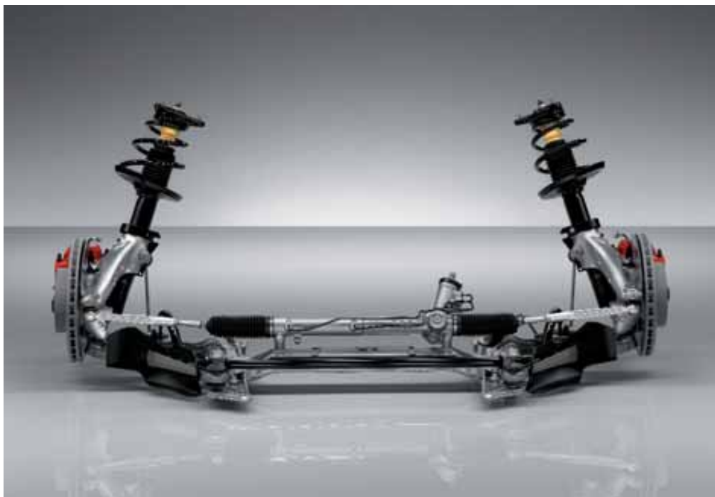
McPherson-Vorderachse mit Querlenkern, Federbeinen beim Cayman S
