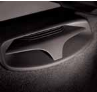
Aktivsubwoofer, 10,2 x 15,3-cm-Tief- tonlautsprecher im Beifahrerfußraum
