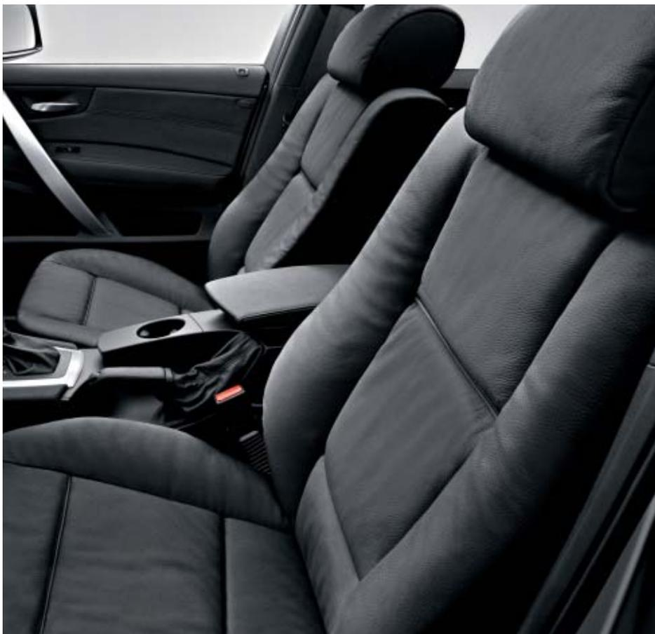
□ **Komfortsitz** für Fahrer und Beifahrer mit Rafftaschen, elektrischer Sitzhöhen- und Lehnen- sowie Längs- und Neigungsverstellung, inkl. Memory-Funktion für Fahrersitz und Außenspiegel (Bordsteinautomatik). Zusätzliche elektr. Verstellfunktionen: variable Schulterabstützung, Kopfstützen und Armauflage vorn.
