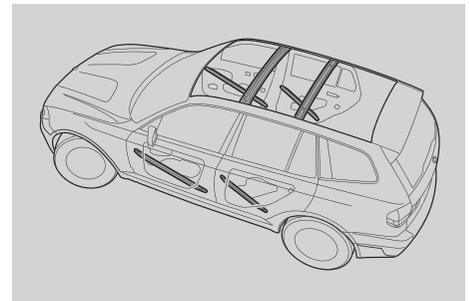
■ **Türverstärkungen** bieten bei einem seitlichen Crash höchstmöglichen Insassenschutz. So genannte Traversen (Verstärkungsprofile) werden hierzu diagonal in die Türen eingesetzt – für eine sehr hohe Türsteifigkeit.
