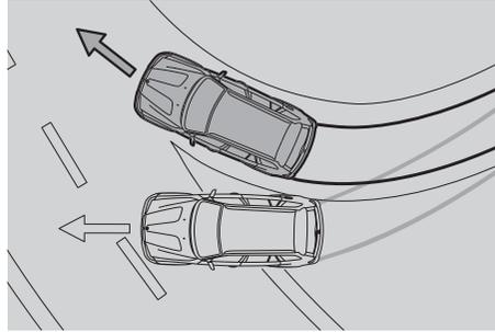
■ **Dynamische Stabilitäts Control (DSC)** mit Zusatzfunktionen, inkl. ADB-X, DTC, DBC und HDC. DSC erkennt eine Schleuderneigung im Ansatz und stabilisiert das Fahrzeug in Millisekunden. Die Unterfunktion Traktionsmodus (DTC) erlaubt erhöhten Radschlupf, um situationsabhängig den Vortrieb zu optimieren und sportlicheres Fahren zu ermöglichen.
