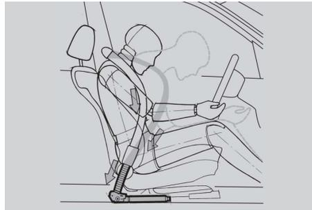
■ **BMW Rückhaltesystem für Fahrer- und Beifahrer** besteht aus einer Kombination von 3-Punkt-Sicherheitsgurt, Gurtstrammer und Gurtkraftbegrenzer. So ist bestmögliche Rückhaltungswirkung bei einer Kollision garantiert.
