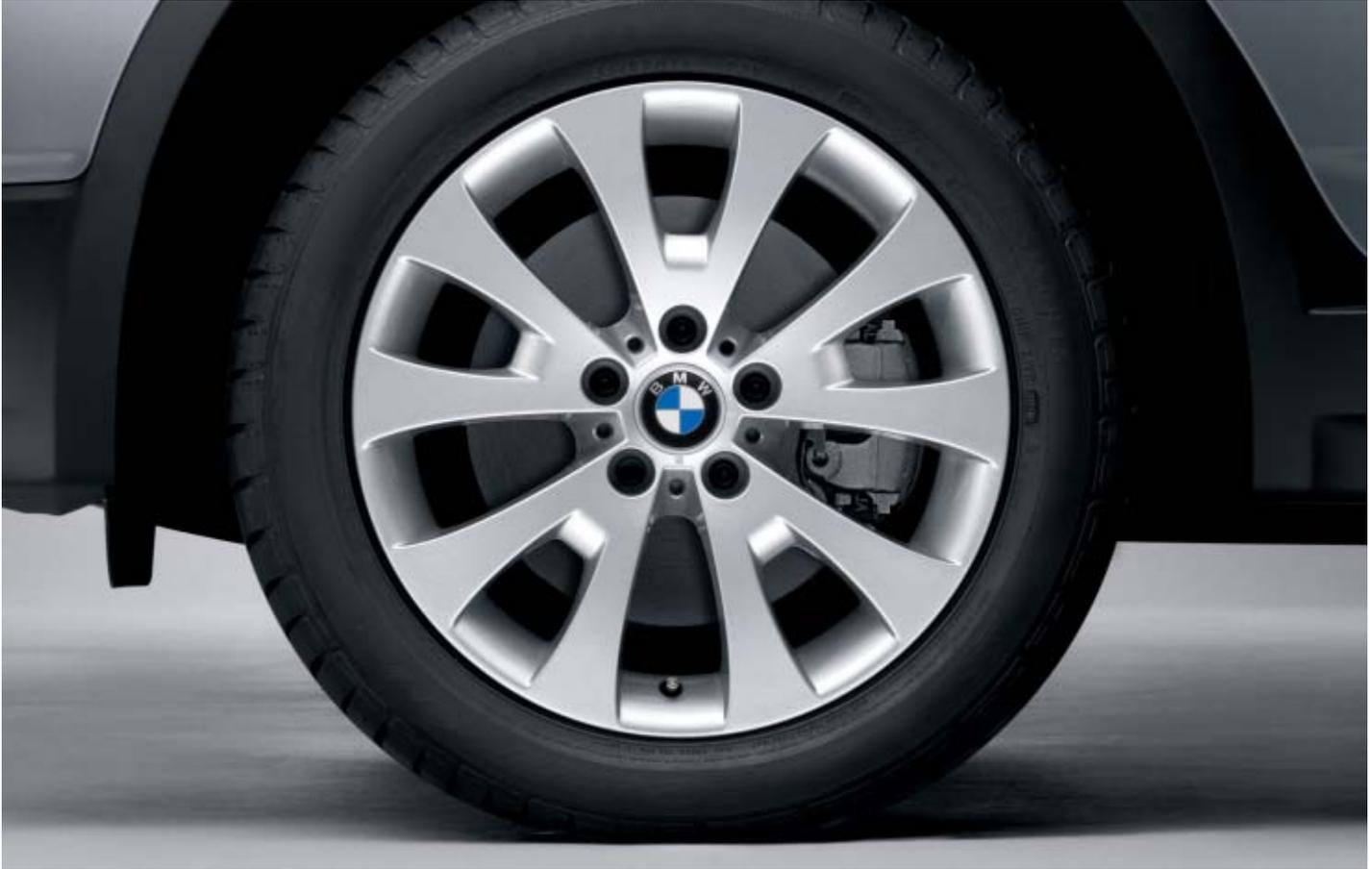
□ **BMW Leichtmetallräder V-Speiche 206**, mit Mischbereifung, vorn 8 J x 18 Zoll, Bereifung 235/50 R 18, hinten 9 J x 18 Zoll, Bereifung 255/45 R 18, inklusive Diebstahlsicherung.
