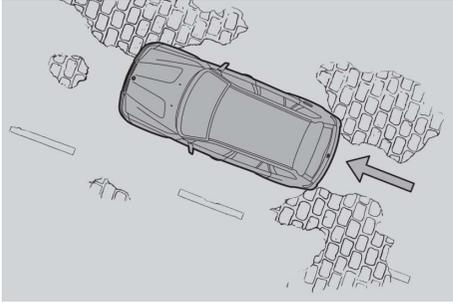
■ **Automatic Differential Brake (ADB-X)** bildet die Funktion von Differenzialsperren nach – durch gezielte Brems Eingriffe an einzelnen Rädern. Neigt ein Rad zum Durchdrehen, wird es von ADB-X autom. gebremst, bis es wieder greift und Antriebskräfte übertragen kann. Bei aktivem DSC wird ADB-X durch eine Motorleistungsregelung ergänzt, bei abgeschaltetem DSC ist die Funktion auf max. Vortrieb ausgelegt.
