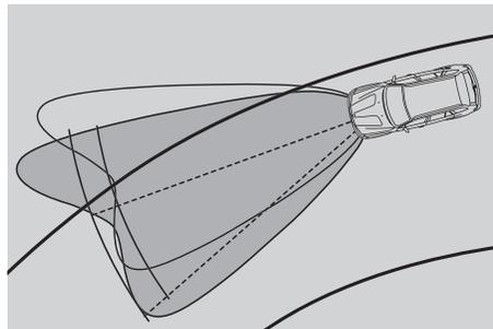
□ **Adaptives Kurvenlicht** verfügt über elektro-mechanisch gesteuerte Scheinwerfer, die jede Kurve optimal ausleuchten, sobald der Fahrer in sie einlenkt – für mehr Fahrsicherheit bei Dunkelheit und schlechten Lichtverhältnissen. Sensoren erfassen Lenkwinkel, Gierrate und Fahrgeschwindigkeit, die Scheinwerfer passen sich dann automatisch dem ermittelten Kurvenverlauf an.
