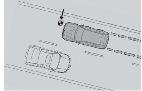
■ **Dynamische Bremsen Control (DBC)** ist eine Bremshilfe, die im Fall einer Notbremsung auch bei unzureichender Pedalkraft sofort den maximalen Bremsdruck aufbaut und den Anhalteweg Ihres BMW deutlich verkürzt.
