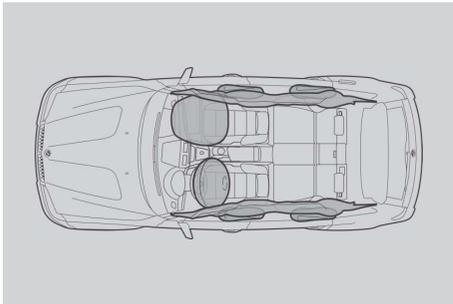
**Airbags** und alle weiteren Sicherheitskomponenten sind in einem BMW optimal aufeinander abgestimmt. So wird bei einer Kollision nur der Airbag ausgelöst, der auch benötigt wird. Bis zu acht Airbags bieten gezielten Schutz: Fahrer- und Beifahrerairbags, durchgehende Kopfairbags vorn und hinten sowie Seitenairbags vorn und auf Wunsch im Fond.
