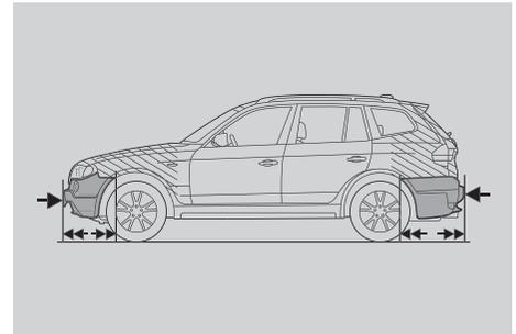
■ **Stoßfänger** mit reversiblen Alu-Pralldämpfern vorn (Stahldämpfer hinten) verkraften Stöße bis 4 km/h schadlos; spezielle Verformungszonen vorn und hinten nehmen Kräfte bis 15 km/h auf, ohne die Karosserie zu beschädigen.
