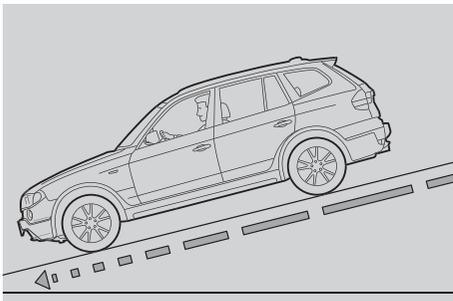
■ **Hill Descent Control (HDC)** ist eine Bergabfahrkontrolle, die dafür sorgt, dass Ihr BMW selbst steile Bergabpassagen automatisch und sicher mit etwas mehr als Schrittgeschwindigkeit bewältigt – ohne dass der Fahrer bremsen muss. Optional ist HDC auch über die Tasten im Multifunktionslenkrad steuerbar.
