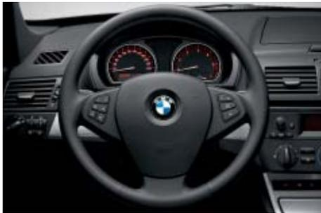
□ **Multifunktion für Lenkrad** für Geschwindigkeitsregelung und Fernbedienung für Radio bzw. Telefon (optional) – hier abgebildet Lederlenkrad, drei Speichen (Serie für 3.0sd).
