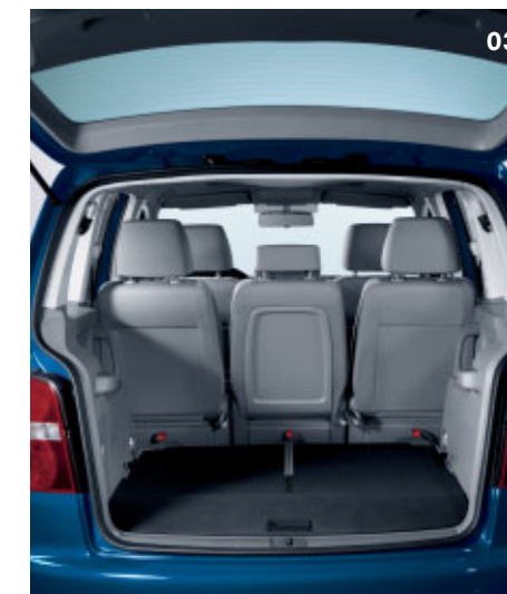
03 Mehr Spielraum: Die drei Einzelsitze der zweiten Sitzreihe – jeder einzelne wiegt nicht einmal 16 Kilogramm. Mit wenigen Handgriffen kommt man von der Siebensitzigkeit mit Kofferraum ...
