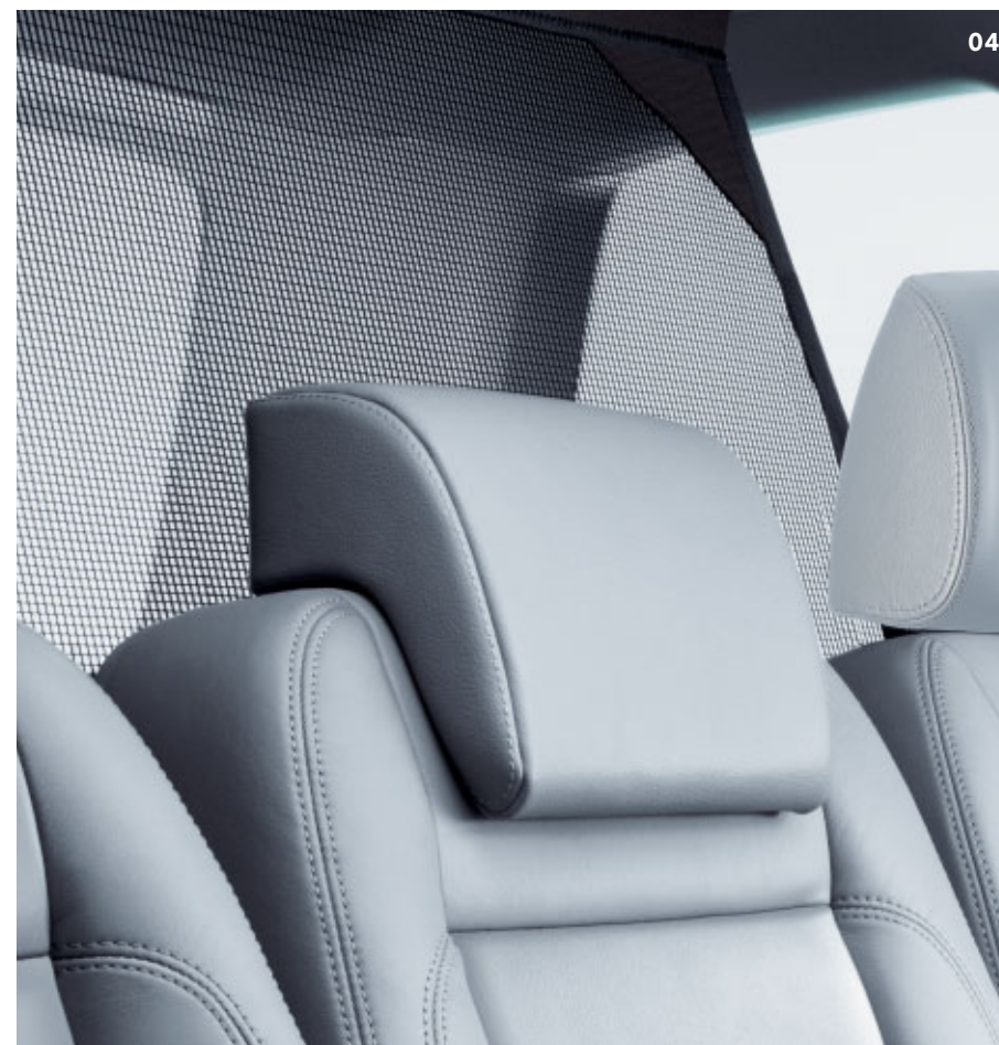
04 Die Netztrennwand für zusätzliche Sicherheit im Fahrgastraum.
