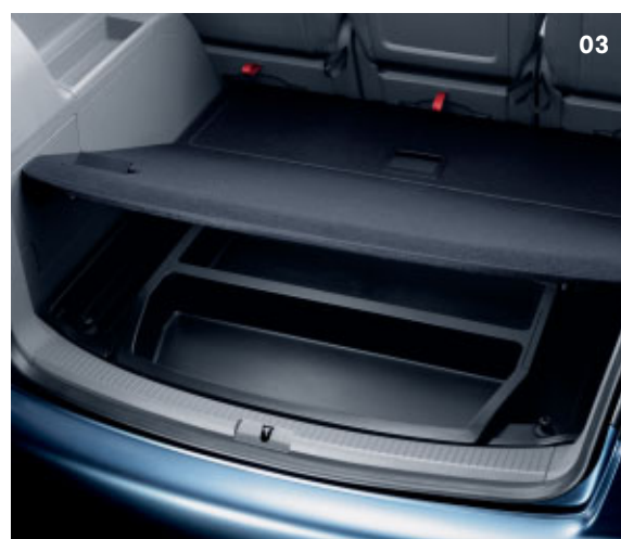
02+03 Der variable Ladeboden : Ein Einsatz unter dem aufklappbaren Boden nimmt zahlreiche Kleinteile auf. Bei Bedarf kann der Ladeboden sogar herausgenommen werden.
