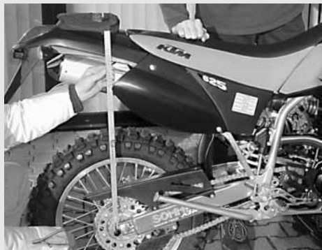
HECK ABGEBOCKT = STATISCHER DURCHHANG
