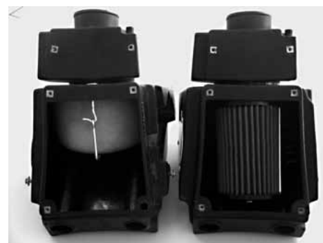
VERGLEICH SERIENLUFTFILTER - KN LUFTFIL- TER KONIFIZIERTER ALUMINIUMEINSATZ
