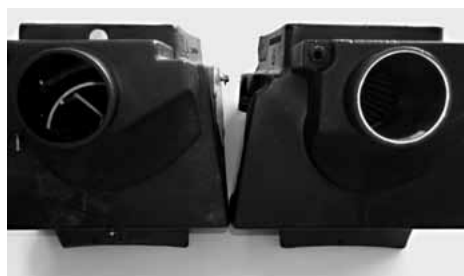
LINKS: „ZERKLÜFTETE“ SERIENLÖSUNG RECHTS: KONSEQUENT KONIFIZIERTE LUFTFÜHRUNG
