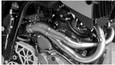
SMC 625 2006 MIT STANDARDLEISTUNGSKIT/DITO PLUS AKRAPOVIC-KRÜMMER UND AKRAPOVIC ENDSCHALLDÄMPFERN OFFEN
