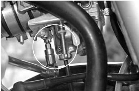
Gemischeinstellung von links per Hand und Biteinsatz oder Spezialwerkzeug.
