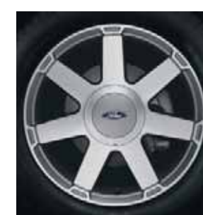
4 Leichtmetallräder 6½ J x 16 im 7-Speichen-Classic-Design, glanzgedreht (Zubehör, Bestell-Nr. 1447898)
