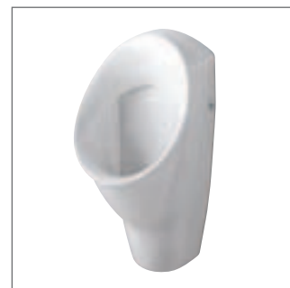
Elektronik-Absaugeurinal 320 x 350 x 620 mm Zu- und Ablauf verdeckt, inkl. elektronischer Urinalsteuerung Modell R 3813 xx*
