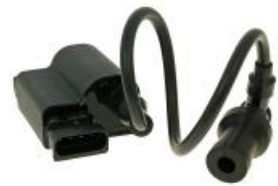
CDI Zündbox mit Spule inkl. Kabel und Stecker für Piaggio 50ccm 4T 2V
