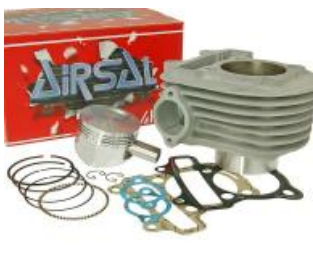
Zylinderkit Airtal Sport 150ccm für GY6, Kymco AC 125/150ccm
