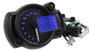
Multifunktions-Tachometer Koso RX2N+ GP Style max 20000 U/min
