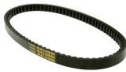
Keilriemen Malossi Kevlar Belt für Piaggio 125-180 2-Takt
