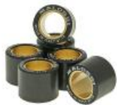
Variomatikgewichte Malossi HT 19x15,5mm - 3,3g
