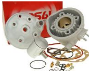
Zylinderkit Airtal M-Racing 50ccm für Minarelli liegend LC
