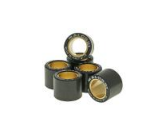
Variomatikgewichte Malossi HT 19x15,5mm - 11,0g
