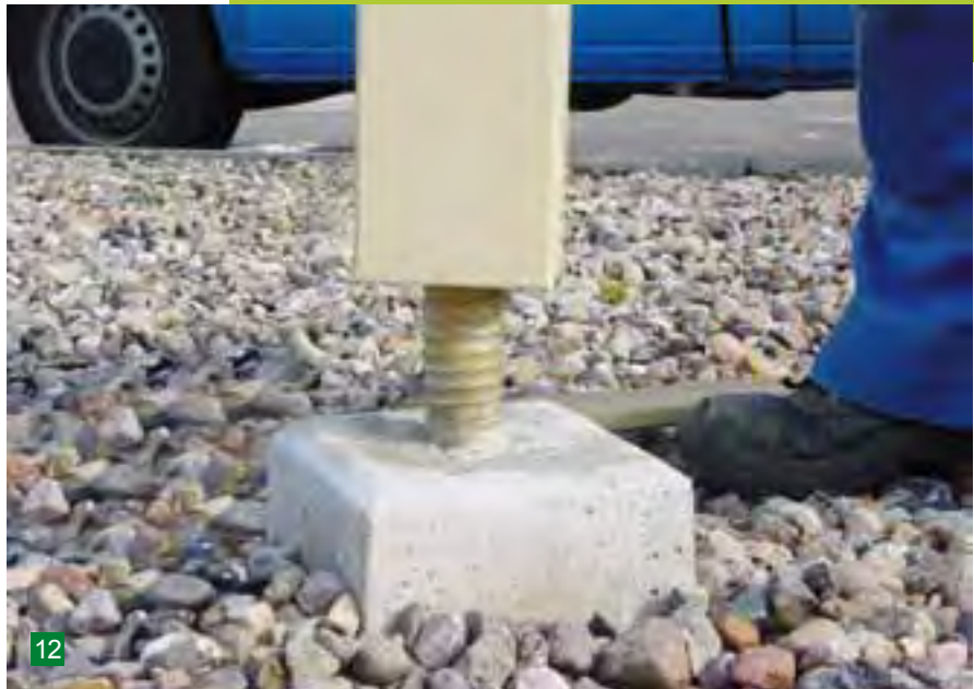
12 Die unsichtbaren Stützenfüße Aus optischen Gründen empfiehlt Joda® den „unsichtbaren“ MGA-Stützenfuß. Dieser ist ein bauaufsichtlich zugelassenes Verbindungsmittel zur Fundament-Verankerung von Holzstützen. Er besteht aus einem Stahlrohr mit Innen- und
