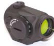
Dies ist die militärische Version des Micro-Leuchtpunktvisiers. Es hat 6 Stufen für die Benutzung mit Nachtsichtgeräten und 7 Stufen für den Tagesgebrauch, wovon 1 besonders hell ist. Eine Weaver-/Picatinnytyp-Montage ist integriert. Die Lebensdauer einer Batterie beträgt ca. 5 Jahre, wenn das Gerät nicht abgeschaltet wird. Bis 25 m Wassertiefe ist es wasserdicht.
