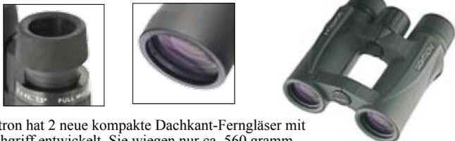
Sightron hat 2 neue kompakte Dachkant-Ferngläser mit Durchgriff entwickelt. Sie wiegen nur ca. 560 Gramm, die Linsen sind mehrfachbeschichtet und die Oberfläche ist grifffreundlich gummiarmiert. Phasenkorrigierte Prismen sorgen für ein helles, kontrastreiches Bild. Der Augenabstand beträgt beim 8x32 17,5 mm und beim 10x32 15 mm und sind damit brillenträgergeeignet. Die Augenmuscheln werden durch kurzes Drehen ein- und ausgefahren.
