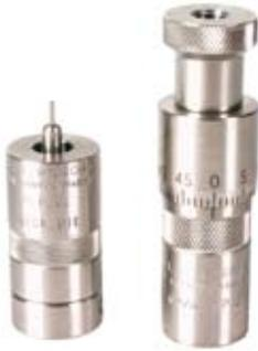
Für einige Kaliber fertigt Wilson jetzt auch Handmatrizen in Stainless Steel. Die Kalibriermatrize unterscheidet sich bis auf das Material nicht von der schon bekannten Kalibriermatrize. Alle Redding Bushings passen. Die Setzmatrize ist durch das Mikrometer Oberteil bequem und fein einstellbar. Je Markierung ändert sich die Setztiefe um 0,025 mm.
