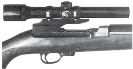
Das Visier muss entfernt werden. In den Schwalbenschwanz wird ein Metallblock geschoben, der eine Gewindebohrung hat, in die eine kräftige Schraube greift und die Montage fest auf dem System fixiert.
