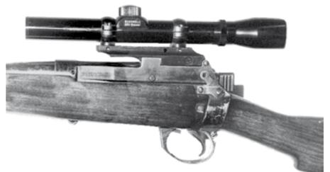
Nach Entfernen des Lochvisiers wird die Montage zwischen die beiden Ohren gesetzt und verschraubt. Ein keilförmiger Block an der Brücke fixiert die Montage vorne - tausendfach bewährt.
