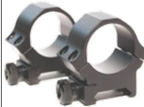
Sun Optics Weaver-Typ Ringe werden aus einer hochfesten Aluminiumlegierung hergestellt. Die Querschraube greift in die Nut der Weaverschiene, was ein Verrutschen der Ringe im Rückstoß verhindert. Mit der massiven Mutter wird die Klemmbacke an das Weaverprofil gedrückt.
