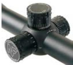
**Sämtliche Bedienelemente befinden sich am Mittelrohr:** Höhen- und Seitenverstellung, Parallaxenausgleich, Schalter für die Absehenbeleuchtung mit Batteriefach. Am Okular befinden sich die Scharfeinstellung und der Vergrößerungswahlring. Die Höhenverstellung und die Seitenverstellung sind in Winkelminuten = MOA (1 MOA ~ 30 mm) eingeteilt. 4 Klicks (1
