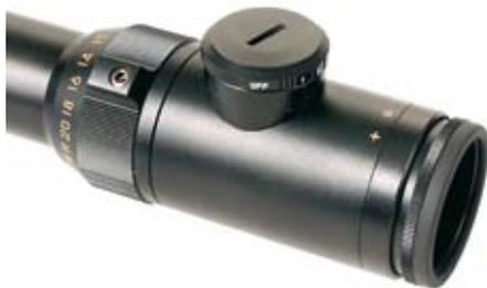
Mit einem Geldstück kann der Deckel des Batteriegehäuses abgeschraubt werden und die Batterie des Typs CR2032 entweder eingesetzt oder getauscht werden. Nach Aufsetzen des Deckels ist das Batteriefach hermetisch abgeschlossen, und es kann keine Feuchtigkeit eindringen. Die Batterielebensdauer beträgt ca. 720 Stunden, je nach Einstellung.
