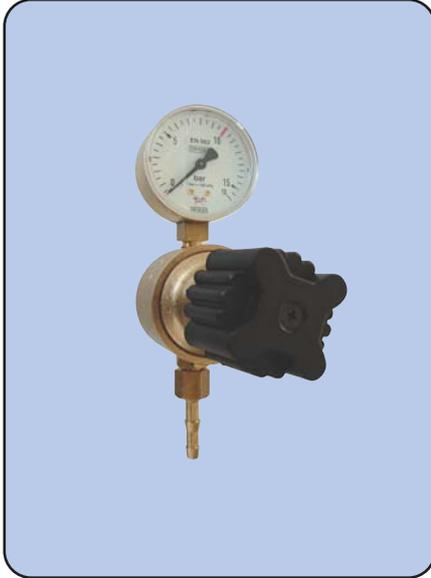
**Entnahmestellendruckregler** dienen dazu, verdichtete, verflüssigte und unter Druck gelöste Gase aus Versorgungsnetzen (Ringleitungen) mit einem bestimmten Vordruck auf den gewünschten Arbeitsdruck zu mindern, und zwar möglichst unabhängig von Entnahmemenschwankungen. Sie sind analog einstufigen Flaschendruckreglern aufgebaut, besitzen jedoch, wegen des relativ niedrigen und bekannten Vordruckes, kein Vordruckmanometer und kein Abblaseventil.
