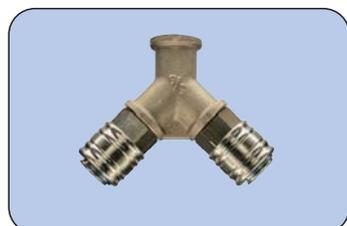
Einhandschnellkupplung mit Walzenverriegelung. Rückschlagventil in der Kupplung, beim Kuppeln zwangsweise entriegelt. Stecker ohne Rückschlagventil.
