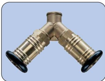
Kupplung mit Kugelverriegelung. Rückschlagventil in der Kupplung. Mit Lippendichtung, daher auch für Wasser geeignet. Gummiring als Verschleisschutz.
