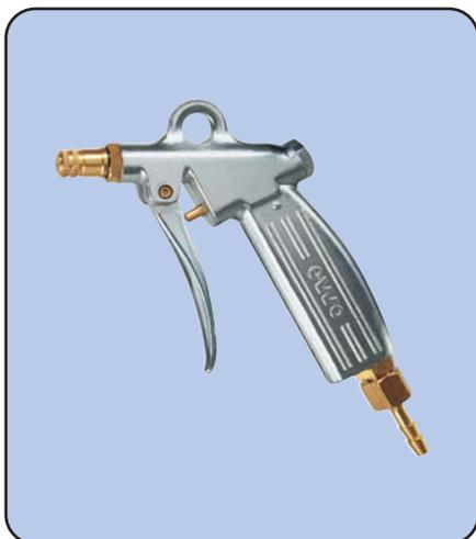
Sprühpistole für dünnflüssige Medien, Düse  $\varnothing 0,7$  mm. Zum Versprühen aus dem Druckbehälter oder aus der Wasserleitung. Betriebsdruck 1 bis 6 bar. Anschluss: lössbare Schlauchverschraubung G  $\frac{1}{4}$  x LW6. Düse mit Dralleinsatz. Betätigung mit Hebel.
