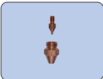
**Schneideinsätze mit Ringdüsen** sind für alle Schneidarbeiten bis maximal 300mm geeignet. Sie arbeiten nach dem Saug- oder Injektorprinzip, d.h. weitgehend rückzündsicher. Schneidsauerstoffbetätigung durch Flügel oder Hebel. Zum Lieferumfang gehören Düsen für Schneidbereich 3-100mm und als Zubehör Führungswagen und Rundführung. Der Acetylendruck beträgt ca. 0,5bar. Sauerstoffdruck und Verbräuche siehe Schneiddüsen oder Bedienungsanleitung.
