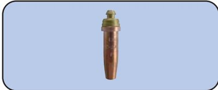
**Schneideinsätze mit Blockdüsen** sind für alle Schneidarbeiten bis max. 200mm geeignet. Vorteile der Blockdüsen: Flammenkegel sind länger, Abstand der Düsenmündung zum Werkstück grösser, daher geringere Verstopfungsgefahr, grössere Schnittgeschwindigkeit, geringerer Gasverbrauch. Schneidsauerstoffbetätigung durch Flügel. Weitgehend rückzündsicher durch Saug- bzw. Injektorprinzip. Acetylendruck beträgt ca. 0,5bar. Sauerstoffdruck und Verbrauch siehe Schneiddüsen oder Bedienungsanleitung.
