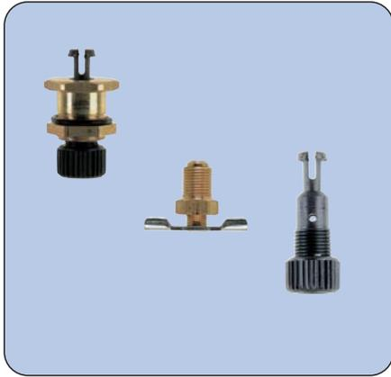
Handbetätigte Ablassventile sind serienmässig in allen Filter- beziehungsweise Filterdruckmindererbehältern eingebaut. Bei Kunststoffbehältern und Metallbehältern mit Schauglas findet die Ablassschraube aus Kunststoff zusammen mit dem entsprechenden Behältereinsetz Anwendung. Der Ventileinsatz aus Metall mit Flügel kommt bei Metallbehältern ohne Schauglas zur Anwendung, kann jedoch auch auf Wunsch anstelle der Ablassschraube in jedes andere  $G\frac{1}{8}$  - Muffengewinde eingeschraubt werden.
