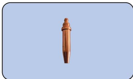
**Einzelschneidbrenner** sind für alle Schneidarbeiten bis maximal 300mm geeignet. Mit den gasemischenden Düsen ist gewährleistet, dass bei einer auftretenden Rückzündung kein Sauerstoff-Brenngasgemisch durch die Gasbohrung in den Brenner zurückzünden kann. Die Schneidsauerstoffbetätigung erfolgt durch Hebel. Als Zubehör gehören zum Lieferumfang der Führungswagen und die Zirkelspitze. (Für Brenngas Propan, siehe Seite 21).
