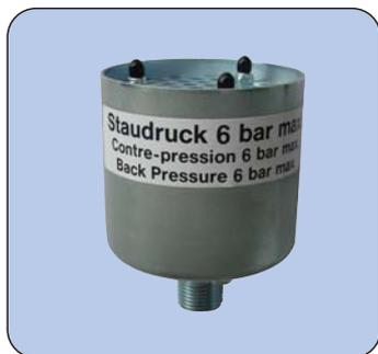
Dieser Schalldämpfer vereinigt in idealer Weise die drei Maximal-Anforderungen an einen Schalldämpfer: hohe Abblasemenge, kurze Entlüftungszeit, grosse Schalldämpfung. Durch den axialen Luftaustritt ist Ausblasen in ungefährlicher Richtung möglich. Temperaturen bis 90°C im Dauerbetrieb, öl- und wasserfest, Reinigung durch Auswaschen mit Benzin usw..
