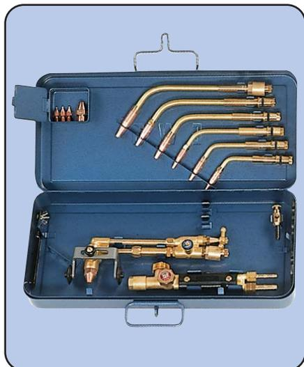
Diese Geräte entsprechen im Wesentlichen den Ausführungen mit 17mm Schaft. Die Grössen 7 und 8 haben jedoch eine höhere Wärmeleistung (Schweißbereich bis 30mm) und die Brenner sind insgesamt robuster und mechanisch höher beanspruchbar. Mit der Acetylen-Sauerstoff-Flamme sind Temperaturen bis 3100°C erreichbar.
