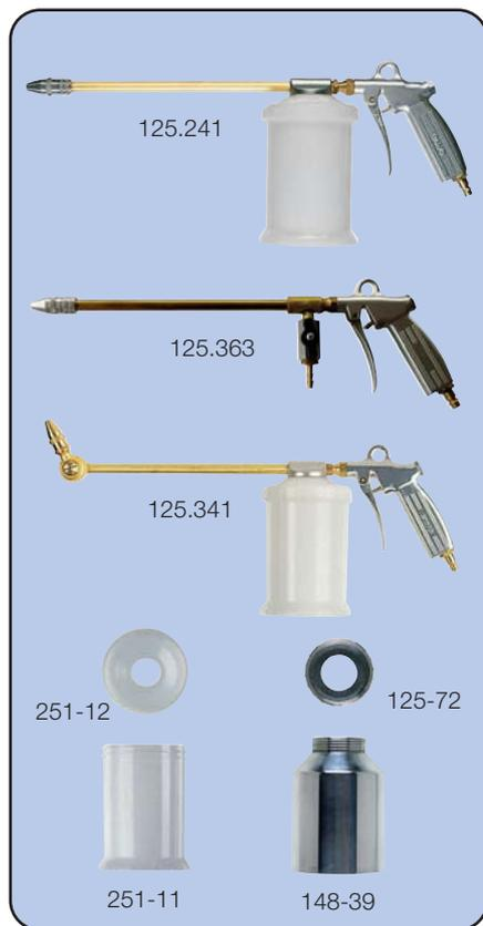
Die Sprühpistole nach dem Saugprinzip für dünnflüssige Medien (z.B. Kaltreiniger). Düse mit  $\varnothing 3$  mm, Strahl verstellbar. Mit geradem oder schwenkbarem Sprührohr. Sprühgutbehälter aus Kunststoff oder mit lösbarer Verschraubung für Schlauchanschluss. Luftanschluss mit Stecker für Schnellkupplung Modell 308 oder durch lösbare Verschraubung.
