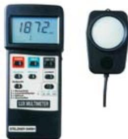
Das professionelle Lux-Multi misst vier verschiedene Lichtarten: Sonnenlicht, Leuchtstofflampen, Natrium- und Quecksilberdampflampen. Das Gerät verfügt über eine Min/Max-Durchschnittsabfrage, Hold Funktion sowie eine Null-Abgleichsfunktion.
