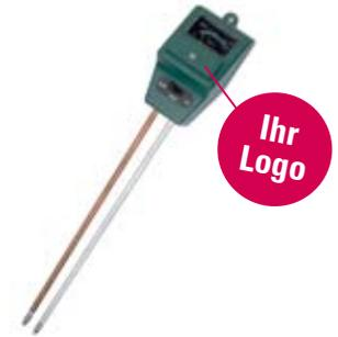
Einfaches Testgerät für Feuchtigkeit, pH-Wert im Boden und der Lichtintensität für Ihre Pflanzen. Der Zeiger zeigt auf der Mehrfachskala den entsprechenden Wert an. Funktioniert ohne Batterie. Die lange Sonde ermöglicht die Messung auch in der Tiefe.
