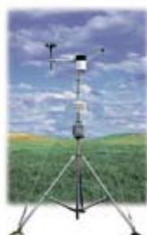
Messung von Temperatur, Boden-, Blatt- und Luftfeuchte, Regenmenge, Licht, Windstärke und -richtung, Luftdruck
