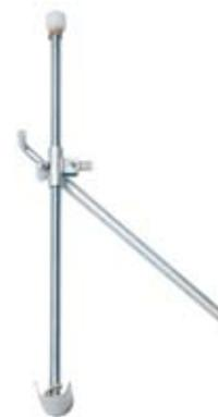
Ziehgerät zum Einhängen in den Pürckhauer. Mit einer Pumpbewegung wird der Pürckhauer aus dem Boden gezogen.
