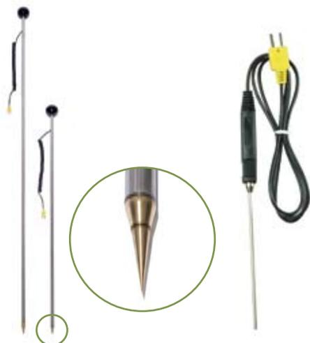
Temperatur-Messsonden mit NiCr-Ni-Element
