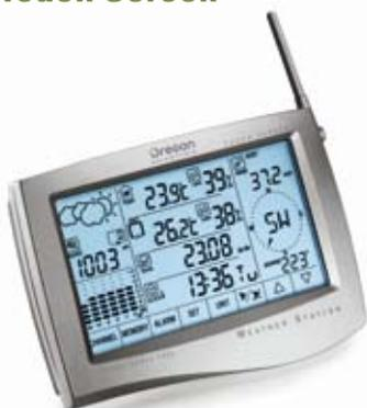
Messung von Temperatur, Luftfeuchte, Regenmenge, Windstärke und -richtung, Luftdruck
