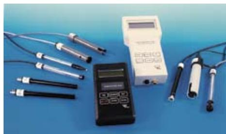
**Messung von NH<sub>4</sub>, K, Cu, NO<sub>3</sub>, Ca, Na, F, Cl sowie Ag/S**
