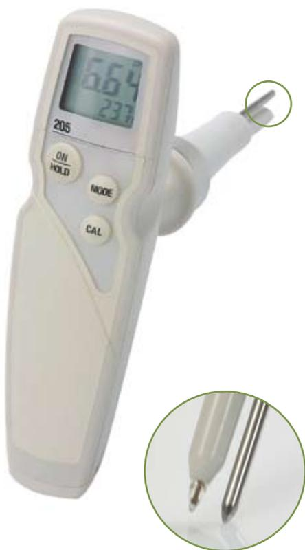
Präzise pH- und Temperatur-Messung für kleine Probevolumina
