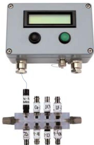
**Messung von NH<sub>4</sub>, K, Cu, NO<sub>3</sub>, Ca, Na, F, Cl sowie Ag/S**
