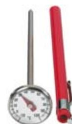
Spritzwassergeschütztes Bimetall-Thermometer mit Edelstahl-Messstab und Schafthalter zum Einstechen.
