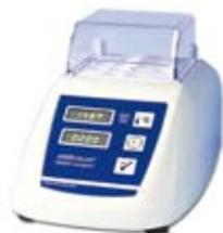
Programmierbarer Thermoblock für chemisch-analytische Probenaufschlüsse mit einfacher Bedienung über Symboltasten, vorprogrammierten Standardprogrammen für alle Routineaufschlüsse und anwenderspezifischen Programmen für eigene Aufschlussmethoden. Hohe Temperaturstabilität und kurze Aufheizzeiten sind weitere Merkmale. Es ist der gleichzeitige Aufschluss von 12 Proben für Rundküvetten mit 16 mm Außendurchmesser möglich.
