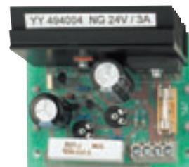
Kompakt dimensionierter und preiswerter Netzteilbaustein. Rasche Montage mittels Schnappbefestigung auf DIN-Schiene. Kurzschlußfest.
