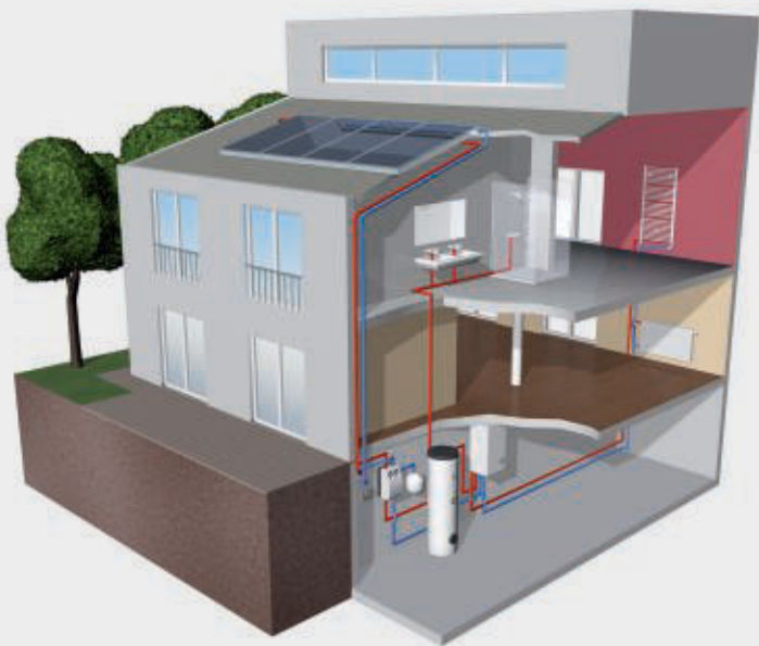
Heizungsanlage in einem Einfamilienhaus: Gas-Brennwertwandkessel EcoTherm Plus WGB mit Solaranlage
