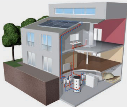
Pellets Lagerung im Kellerraum. Die Pelletsbeschickung und -entnahme geschieht vollautomatisch, kontinuierlich und flüsterleise.
