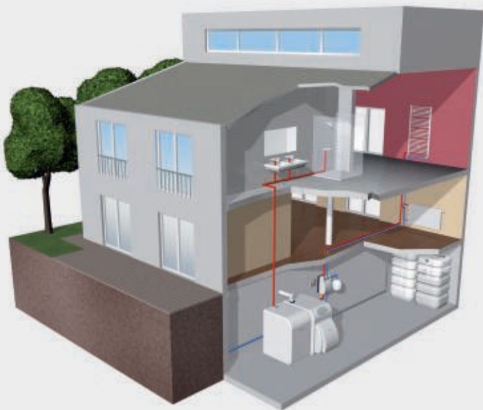
Heizungsanlage in einem Einfamilienhaus: Öl-Brennwertkessel NovoCondens SOB mit Schichtenladespeicher EAS SSP 130 C
