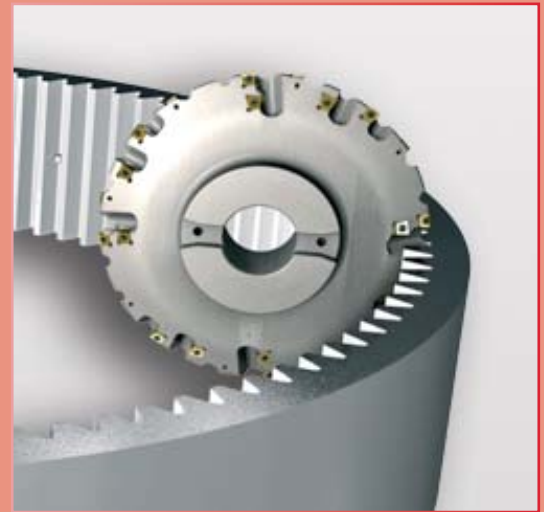
Vorfräsen eines Hohlrades Modul 16 Roughing of annulus module 16
