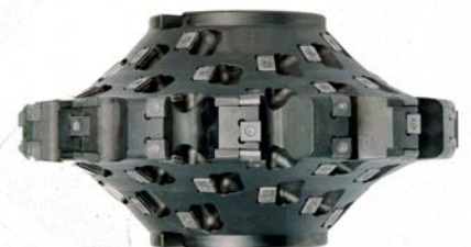
Zahnformvorfäser Modul 60, \varnothing 520 mm Roughing gasher module 60, dia. 520 mm
