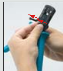
Zange drehen und Bolzen bis Anschlag herausziehen
