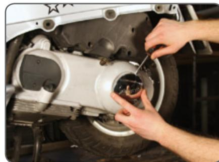
Um den Variatordeckel abzunehmen, muss die Plastikverkleidung vor der Kupplungsmutter entfernt werden...
