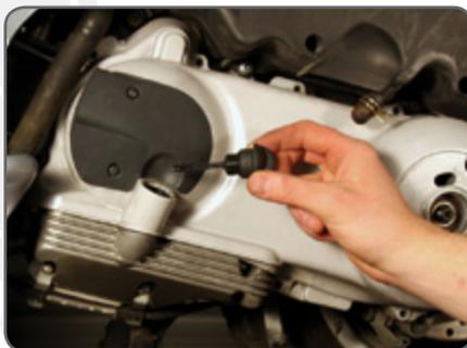
Der Ölmesstab (nur bei LEADER Motoren vorhanden, der alte ET4 Motor besitzt ein Ölschauglas) muss...
