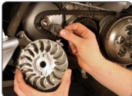
Hinter der Riemenscheibe/ des Lüfterrads sitzt eine Distanzscheibe die bei Montage nicht vergessen werden darf!
