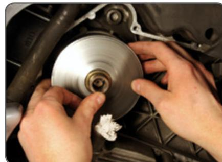
...und dann die Variomatik von der Welle ziehen – fertig! Bei Montage der Variomatik unbedingt darauf achten das bei Montage des Variators die Verzahnung der Welle nicht leidet!
