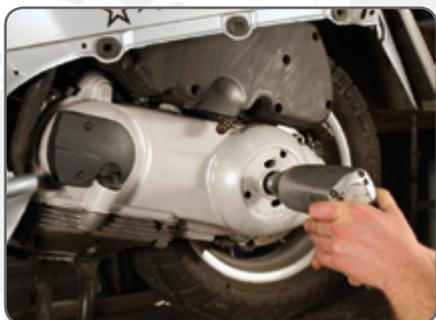
Die Mutter des Variatorgehäuses mit einer 19er Nuss und entweder mit einem Schlagschrauber oder einer Ratsche lösen.
