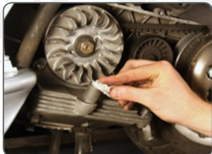
Um Fremdkörper in der Ölwanne zu vermeiden empfehlen wir diese mit einem Stück Stoff zu verschließen.
