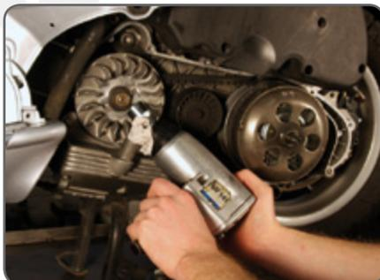
Anschließend kann die Mutter der Variomatik ebenfalls mit einer 19er Nuss gelöst werden. Hat man keinen Schlagschrauber zur Hand, kann das System mit einem Haltewerkzeug für die Variomatik blockiert werden.
