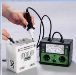
Plattenbau-Check: Isolationstest bei geöffneter „Schädeldecke“ an noch unbefüllter Batterie.
