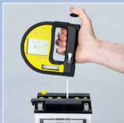
Sieht unspektakulär aus, hat es aber in sich: Das Dichte-Messgerät mit Temperatur-Kompensation.
