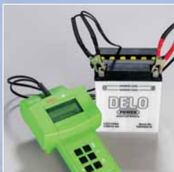
Zustands-Analysegerät mit Protokoll-Ausdruckfunktion für den mobilen Einsatz.
