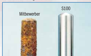
Anwendungsbeispiel: Mit unterschiedlichen Produkten behandelte Metallstäbe nach 151 Tagen = 5 Monaten
