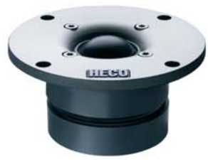
Hochtöner mit 25 mm Gewebe-Kalotte, Aluminium Frontplatte mit kurzem Hornansatz und Doppelmagnetsystem
