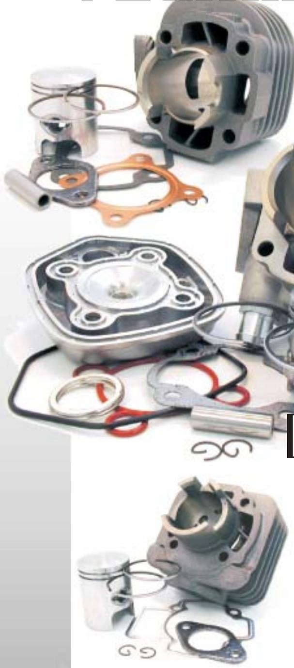
Ihr wollt einen 50ccm Nachbauzylinder, der mehr kann als der originale aus Grauguß? Dann haben wir für euch genau das richtige. Der BGM 50ccm Nachbau aus feinstem Aluminium mit einer ultraharten Nicasil - Beschichtung.
