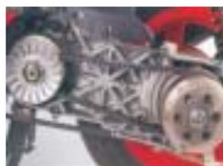
Keilriemen, Riemenscheibe etc. werden wieder montiert. Die Mutter auf der Kurbelwelle wird mit etwas Loctite (flüssige Schraubensicherung) versehen.
