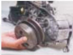
Danach werden wie nebenan beschrieben Variomatik, Keilriemen und hintere Riemenscheibeneinheit ausgebaut.
