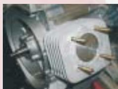
Hier sollte nochmals kontrolliert werden ob der Kolben richtig herum eingebaut wurde (Pfeil zum Auslaß!). Sollte der Zylinderkopf über O-Ringdichtungen verfügen, können diese mittels ein wenig Fett in Position gehalten werden.
