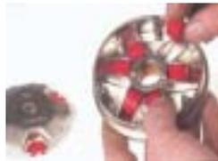
Die neue Variomatik wird mit den mitgelieferten Gewichten bestückt (diese werden bei Sportvarios NICHT gefettet, wir empfehlen euch hier die Verwendung von Teflonspray). Die Gleitschuhe werden in die entsprechenden Aussparungen an Steigscheibe gesteckt.
