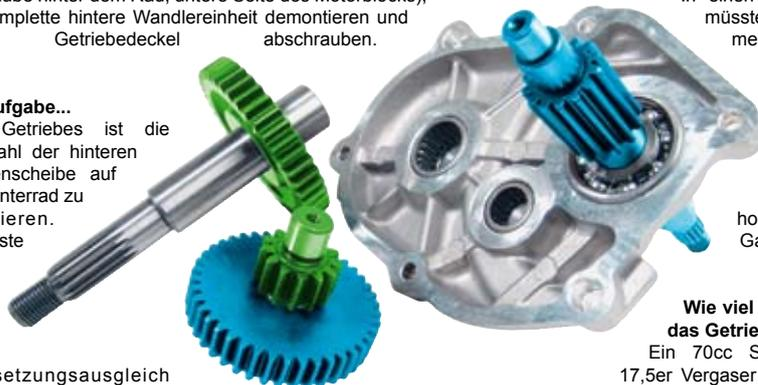
Drehzahl in mehr Endgeschwindigkeit umgesetzt. Voraussetzung dafür ist aber, dass der Motor genug Kraft hat das längere Getriebe zu ziehen. Ein Getriebe bei einem Standardmotor zu verlängern bringt also nichts. Im schlimmsten Fall, wenn das Getriebe viel zu lang gewählt wurde, kann der Motor sogar langsamer laufen als vorher. Sehr einfach könnten Sie sich das immer anhand einer Fahradschaltung verdeutlichen.
