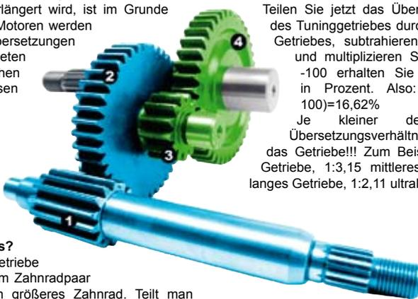
Teilen Sie jetzt das Übersetzungsverhältnis des Tuninggetriebes durch das des original Getriebes, subtrahieren Sie den Wert 1 und multiplizieren Sie das Ganze mit -100 erhalten Sie die Verlängerung in Prozent. Also:  $((2,56:3,07)-1) \times (-100) = 16,62\%$
