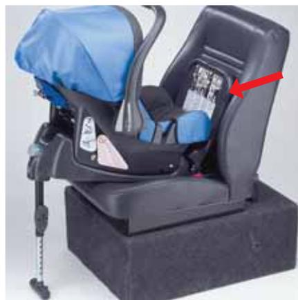
Der extra dafür ausgestattete RÖMER BABY-SAFE ISOFIX plus wird auf dem ISOFIX-Adapter befestigt. Wichtig bei entgegen der Fahrtrichtung eingebauten Systemen: Die Rückprallplatte drückt im Falle eines Heckaufpralls gegen die Fahrzeug-Rückenlehne und optimiert so die Schutzwirkung.
