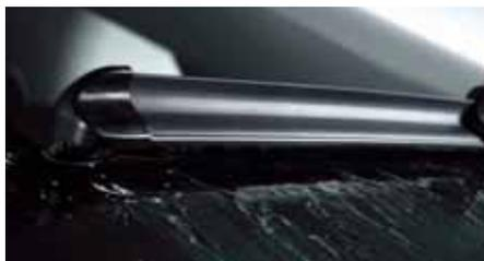
Die „**Aero-Blade**“-Scheibenwischer sind mit einer integrierten Spoilerlippe versehen, die den Anpressdruck auf die Scheibe erhöht und dadurch auch bei hoher Geschwindigkeit eine gleichmäßige Reinigung gewährleistet. Die geringe Strömungsangriffsfläche vermindert zudem die Windgeräusche.
