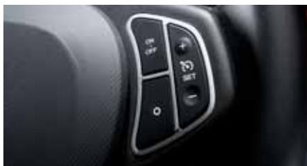
Die **Geschwindigkeitsregelanlage** erlaubt entspanntes Dahingleiten in fließendem Verkehr, etwa auf der Autobahn. Die Bedientasten sind rechts ins Lenkrad integriert. Das System (Serie im 2.0 CVVT TX) speichert das vom Fahrer gewählte Tempo und wird per Tastendruck oder durch Betätigung von Bremse oder Kupplung deaktiviert.
