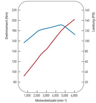
Max. Leistung (kW/PS bei min<sup>-1</sup>): 105/143 bei 6.000
