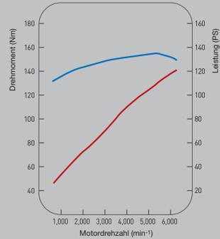
Max. Leistung (kW/PS bei min<sup>-1</sup>): 90/122 bei 6.200
