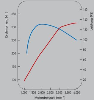
Max. Leistung (kW/PS bei min<sup>-1</sup>): 103/140 bei 4.000
