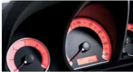
Die **Instrumenteneinheit** ist dank der eleganten schwarzen Ziffern auf weißem Grund jederzeit leicht ablesbar. Das sportlich-funktionale Styling der Rundenanzeigen (von links: Drehzahlmesser, Tachometer, Wassertemperatur- und Tankanzeige) und ihre rot-orangefarbene Hintergrundbeleuchtung geben dem Cockpit eine ganz eigene Note.
