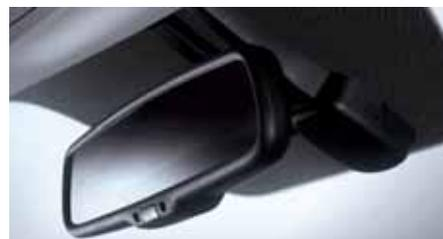
**Regensensor** und **selbstabblendender Innenrückspiegel** verbessern bei ungünstigen Verhältnissen die Sicht: Der Sensor aktiviert bei Nässe auf der Frontscheibe den Scheibenwischer und passt das Wischintervall der Niederschlagsstärke an, der elektrochromatische Rückspiegel reduziert automatisch störende Reflexionen (beides Serie in TX, optional für EX).
