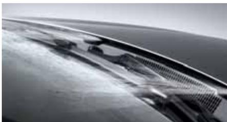
Die **Scheibenwaschdüsen** sind unter dem oberen Haubenrand platziert. Dieser Windschutz und der breite Sprühstrahl der Düsen gewährleisten bei jeder Geschwindigkeit eine optimale Reinigungswirkung im Wischerfeld.
