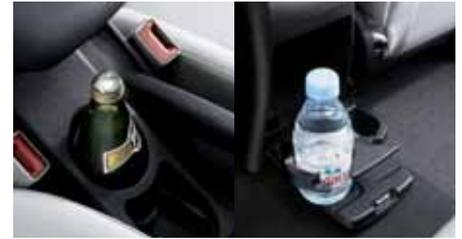
Ein **Getränkehalter** befindet sich vorn neben der Handbremse. Er ist besonders tief und damit auch für große Flaschen geeignet. Den Fondpassagieren stehen zwei weitere Getränkehalter zur Verfügung (Serie ab EX, optional für LX), die hinten aus der Mittelkonsole ausgeklappt werden.
