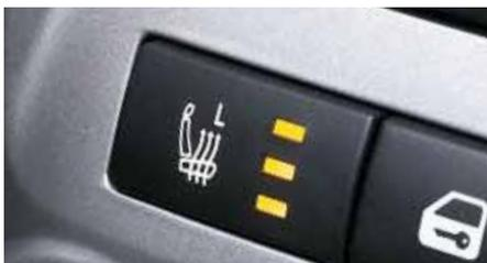
Eine **dreistufige Sitzheizung** für die Vordersitze (Serie in TX, optional für LX und EX) schafft angenehme und veränderbare Wärme an kühlen Tagen. Die Bedientasten befinden sich in der Zentralkonsole und sind für Fahrer wie Beifahrer bequem erreichbar.
