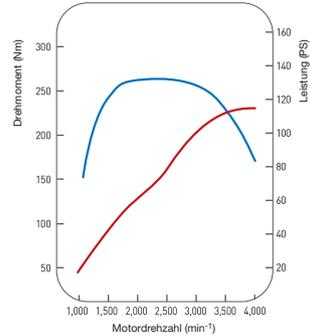
Max. Leistung (kW/PS bei min<sup>-1</sup>): 85/115 bei 4.000
