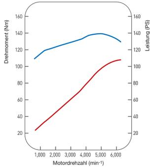
Max. Leistung (kW/PS bei min<sup>-1</sup>): 80/109 bei 6.200
