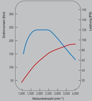
Max. Leistung (kW/PS bei min<sup>-1</sup>): 66/90 bei 4.000
