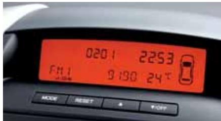
Das **Multifunktionsdisplay** oben in der Zentralkonsole zeigt Uhrzeit und Datum an und informiert den Fahrer über Außentemperatur, Momentan- und Durchschnittsverbrauch sowie Durchschnittsgeschwindigkeit und warnt bei nicht geschlossenen Türen. Außerdem lässt sich hier dank der Reifendrucksensoren (ab Juli 2007, ab LX) der Luftdruck der Reifen ablesen.
