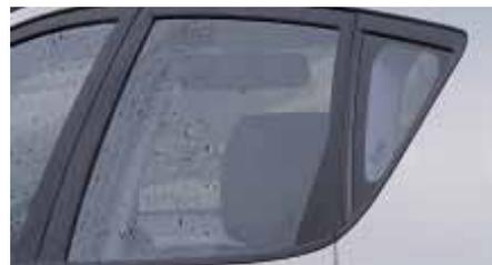
Die **Wasser abweisenden Seitenfenster** (ab EX-Version) sind dank Nano-Technologie mit einer Beschichtung versehen, die kleine Poren im Glas versiegelt und so die Haftspannung herabsetzt. Regentropfen finden keinen Halt mehr und werden vom Fahrtwind mitgerissen. Damit hat der Fahrer bei Regen freiere Sicht, auch auf die Außenspiegel.
