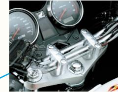
Durch Drehen der Lenkeraufnahme um 180 Grad kann der Lenker für größere Fahrer um 20 mm nach vorne verstellt werden.
