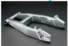
Die leichte aber stabile Aluminium-Kastenschwinge besitzt geschmiedete Endstücke, in denen die untere Federbein-Aufnahme integriert ist.
