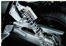
Die konventionellen Federbeine mit externem Ausgleichsbehälter zeichnen sich durch fünffach verstellbare Federvorspannung und Zugstufe aus.
