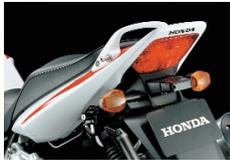
Das helle LED-Rücklicht ist sauber in die Unterseite der Heckverkleidung integriert.
