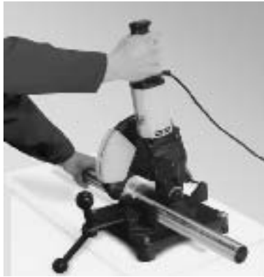
Bild 7: Ablängen des Systemrohrs mit der elektromechanischen Säge
