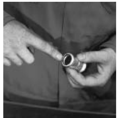
Bild 13: Prüfen des Dichtrings
