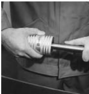
Bild 9: Außenentgraten des Systemrohrs mit dem Handentgrater
