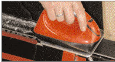
2: Die Temperatur am Wacheisen auf 145°C/150°C einstellen. Dann mit dem Wacheisen einmal flott über den Belag fahren. Eine Belagslänge sollte in einer Dauer zwischen 3 - 5 Sekunden eingebügelt werden.
