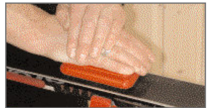
3: Zum Ausbürsten die Roßhaarbürste (T0157) verwenden. Durch kräftiges Hin- und Herbürsten das Pulver in die Belagsstruktur weiter einpolieren.
