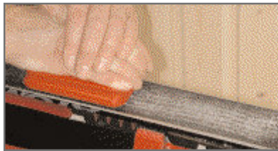
3: Bürsten Sie den Belag mit der Roßhaarbürste (T0157B) oder der festen schwarzen Nylonbürste (T0194B) ca. 10 Mal. Hinweis: FC7 muß nach dem Aufbürsten ein zweites Mal gebügelt werden.
