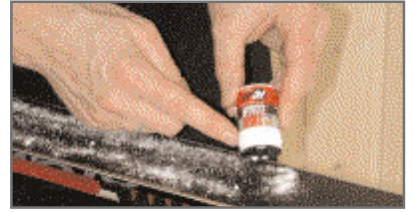
1: Verteilen Sie eine gleichmäßige Puderschicht auf dem Belag. Beim Einkorken brauchen Sie weniger Pulver als beim Aufbringen mit dem Wacheisen.
